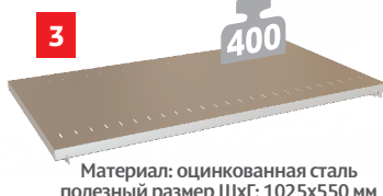
Универсальная перфорация: круг d=7 мм, шаг 25x38 мм квадрат b=10 мм, шаг 38x38 мм
