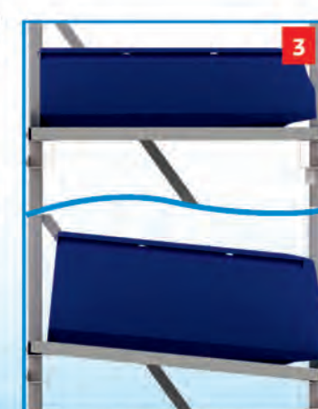
Установка полок под углом до 20°
